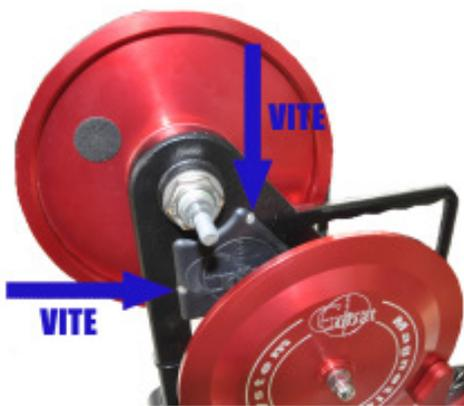
Utilizzando una chiave a brugola da 2 mm. svitare le due viti indicate in figura. Una terza vite è inserita stabilmente nella struttura dell' MD nell'angolo inferiore destro del coperchio di alloggiamento della Scheda Madre. Questa vite funge da semplice sede di inserimento del coperchio e NON deve essere svitata. Una volta estratte le due viti indicate, tirare leggermente il coperchio in modo da estrarlo dalla propria sede.
