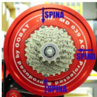
Per ottenere il Blocco della Ruota Libera della Cassetta Pignoni, allineare come prima cosa le 7 spine del sistema di blocco in fase con la dentatura del pignone da 28 denti della cassetta.
