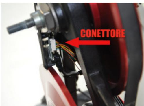
Portata in vista la Scheda Madre, provvedere con **ATTENZIONE** a scollegare il connettore del cablaggio. Un danneggiamento del cablaggio comporterebbe infatti dover inviare il MD in Ditta per la sostituzione del componente. Per questa operazione si consiglia l'uso di un piccolo cacciavite piano per scollegare il connettore dall'attacco femmina della scheda.
