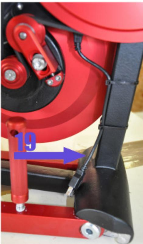
Il cavetto fusibile di collegamento al PC ( 19 ) prevede un connettore Mini USB dritto ed è assicurato alla parte verticale della struttura dell’ MD con due fascette di plastica. Anche in questo caso il sistema serve a preservare la Scheda Elettronica Madre del sistema da eventuali strappi del cavo di collegamento. A differenza della scheda controllo motore, la scheda madre può però essere sostituita senza inviare il MD in Ditta.
